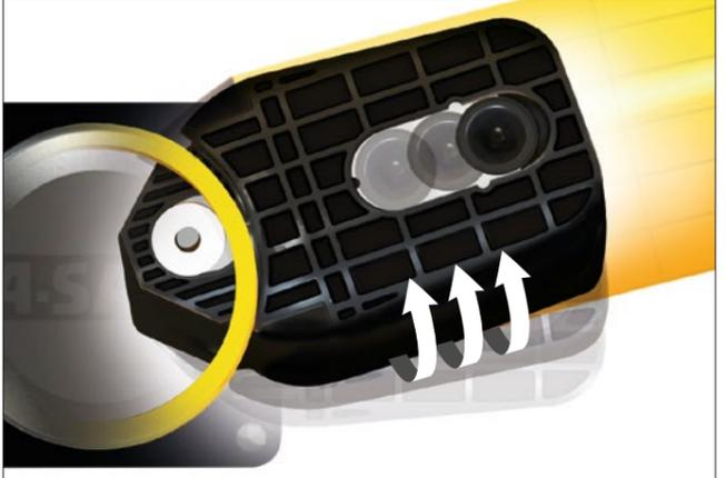
**FASE 3:** Al picco della forza d'urto, l'accoppiatore gira ulteriormente bloccando il fissaggio interno al paletto generando una torsione dello stesso in modo da disperdere le forze rimanenti.
