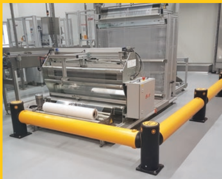
Elastyczna bariera pojedyncza iFlex zabezpieczająca maszyny pakujące.
