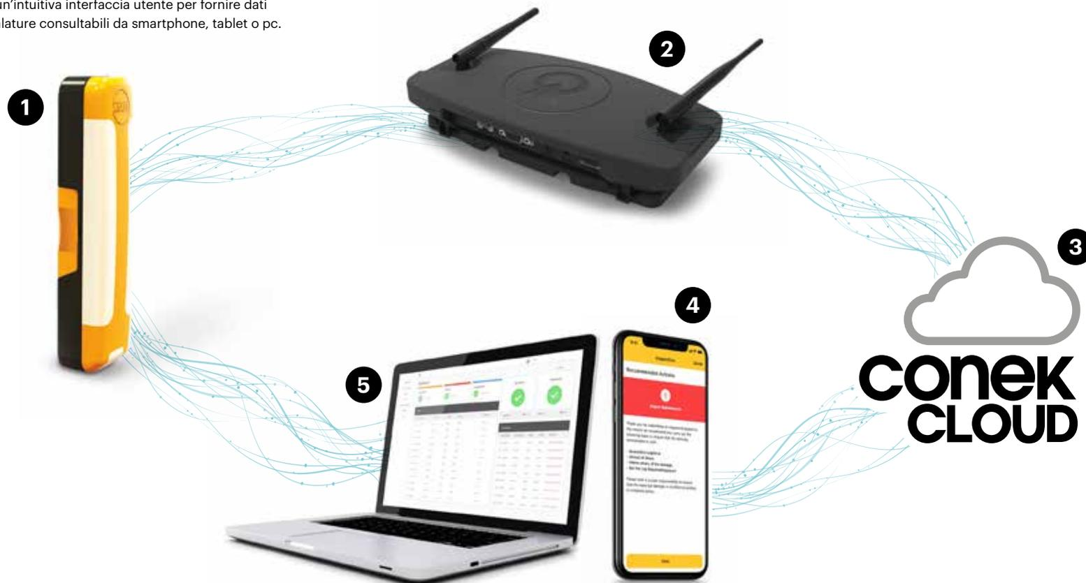
**1** I sensori montati sulle gambe delle scaffalature rilevano istantaneamente gli impatti. Se l'impatto registra parametri superiori al normale, il sistema attiva un avviso. Una luce rossa sul sensore lampeggia come avvertimento visivo per il conducente del veicolo.
