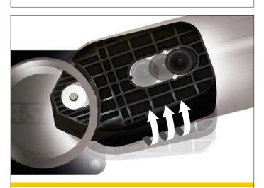
FASE 3: Al picco della forza d'urto, l'accoppiatore gira ulteriormente bloccando il fissaggio interno al paletto generando una torsione dello stesso in modo da disperdere le forze rimanenti.
