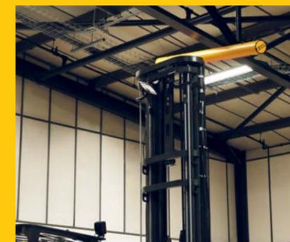
La barra di allarme fornisce un allarme acustico per avvisare il conducente di un veicolo.
