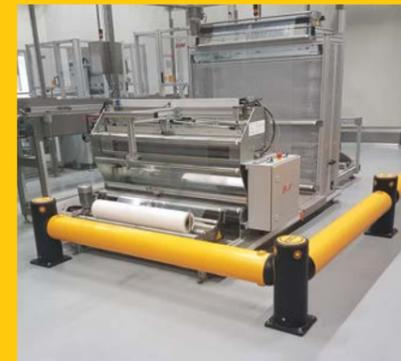
Barriera iFlex Traffic con singolo respingente per la protezione di macchinari in un'azienda di packaging.
