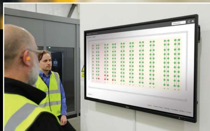
Schermata rackeye: con una comoda mappa 2d puoi controllare “a colpo d’occhio” e in tempo reale lo stato delle scaffalature nel tuo magazzino
