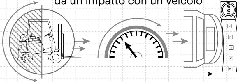
$$\frac{1}{2} \text{ Massa} \times \text{Velocità}^2 = \text{Joules}$$
