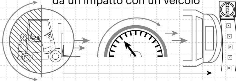
$$\frac{1}{2} \text{ Massa} \times \text{Velocità}^2 = \text{Joules}$$
