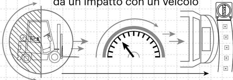
$$\frac{1}{2} \text{ Massa} \times \text{Velocità}^2 = \text{Joules}$$
