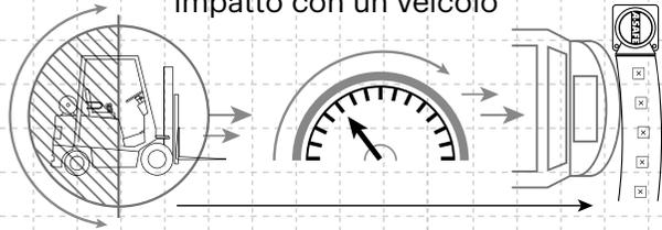
$$\frac{1}{2} \text{ Massa} \times \text{Velocità}^2 = \text{Joules}$$
