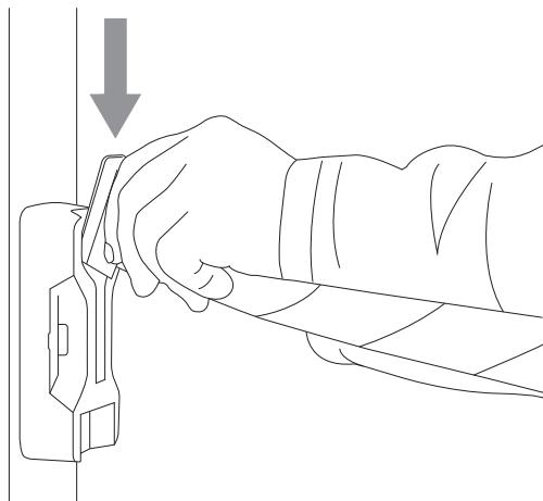
Coloca el extremo de la cinta retráctil en la placa receptora asegurándote de pasarlo hasta que haga tope.
